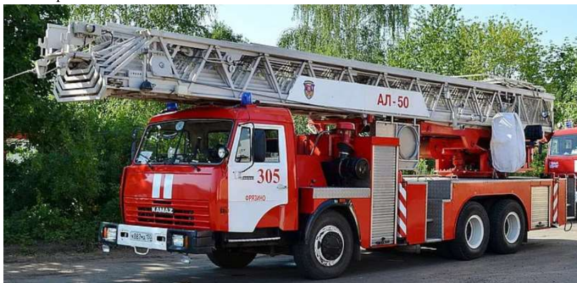
Рис. 4 – Автолестница пожарная АЛ-50 (шасси КАМАЗ-65115 6х4). Источник [17]
