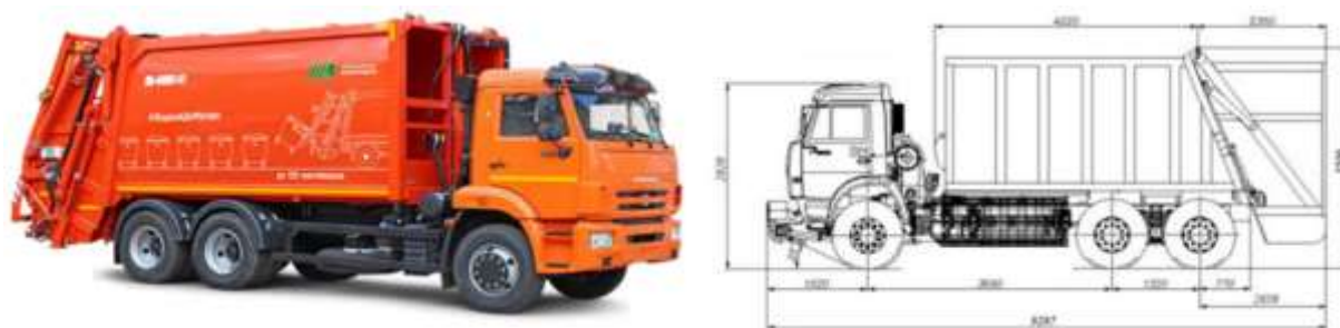
Рис. 76 – Мусоровоз МК-200 на шасси КАМАЗ-65115 (6х4)
