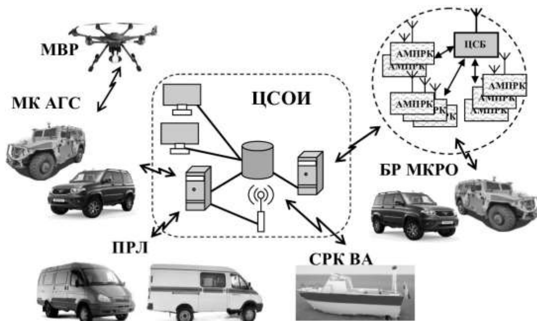
Рисунок 1 – Предлагаемый основной состав мобильных средств контроля и оценки обстановки ПМОО. (ЦСОИ – центр сбора и обработки информации, ПРЛ – передвижная радиометрическая лаборатория; БР МКРО – быстро-развертываемый модуль контроля радиационной обстановки; ЦСБ – центр сбора данных (блок); АМПРК – автономный малогабаритный пост радиационного контроля; МК АГС – мобильный комплекс аэрогамма съемки; МВР – модуль воздушной разведки; СРК ВА – средство радиационного контроля водной акватории. Транспортные платформы средств могут быть выполнены на базе автомобилей, с учетом особых условий зоны ВК.
